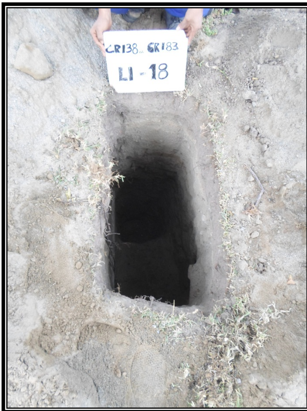
Foto N° 7 y 8: Ubicación de la calicata LI-18 se presenta un material removido conformado por arenas de grano fino, con gravas de 1" aisladas y raíces en un espesor de 0.80m, subyaciendo hasta la profundidad explorada de 2.00m con arenas de grano fino, no plástica, de color beige, húmeda, con micas, en estado semicompacto.
