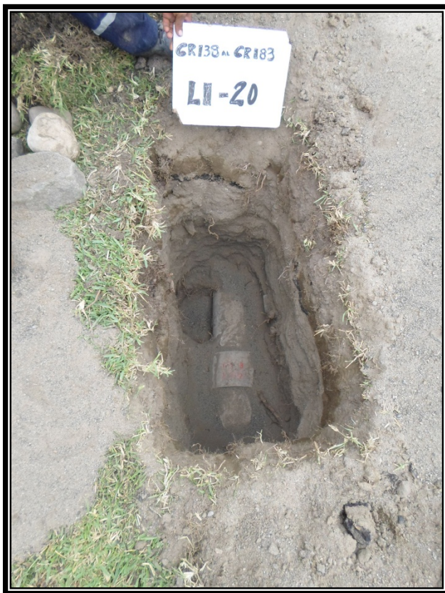
Foto N° 11 y 12: Ubicación de la calicata LI-20 se presenta un material removido conformado por arenas limosas, con gravas angulosas y raíces en un espesor de 0.40m, continuando hasta la profundidad de 1.50m un material removido, consistentes en arenas de grano grueso, no plástica, de color beige, húmeda, en estado semicompacto, subyaciendo hasta la profundidad explorada de 2.00m con arenas con limos, de grano medio a grueso, no plástica, de color beige, poco húmeda, con gravas angulosas de tamaño máximo 4", en estado semicompacto. Nota: a la profundidad de 1.00m pasa una tubería de concreto de diámetro 8".
