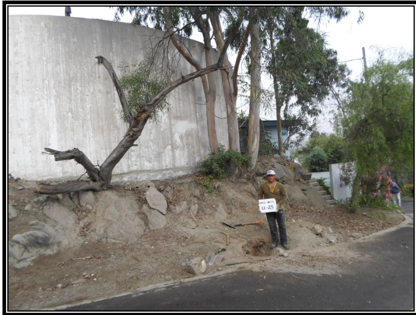
Foto N° 21 y 22: Ubicación de la calicata LI-25 se presenta un material removido conformado por arenas limosas, con presencia de gravillas de \frac{1}{2} " aisladas y raíces en un espesor de 0.10m, continuando hasta la profundidad de 0.50m con la roca intrusiva (granodiorita), en estado muy meteorizado, al excavar se presenta como arena limosas, con gravas, en estado semicompacto a compacto, subyaciendo hasta la profundidad explorada de 0.60m con la roca intrusiva (granodiorita), en estado sano de difícil excavación manual.
