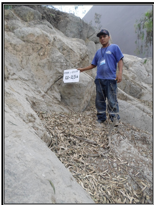
Foto N° 23 y 24: Ubicación de la calicata LI-25A (corte de talud) se presenta hasta la profundidad de 1.00m roca intrusiva (granodiorita), en estado sano de difícil excavación manual
