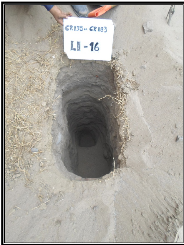
Foto N° 3 y 4: Ubicación de la calicata LI-16 se presenta un relleno conformado por arenas limosas, con gravas angulosas, con presencia de raíces y trozos de ladrillos en un espesor de 0.70m, subyaciendo hasta la profundidad explorada de 2.20m con arenas de grano fino, no plástica, de color beige, húmeda, con micas, en estado semicompacto.
