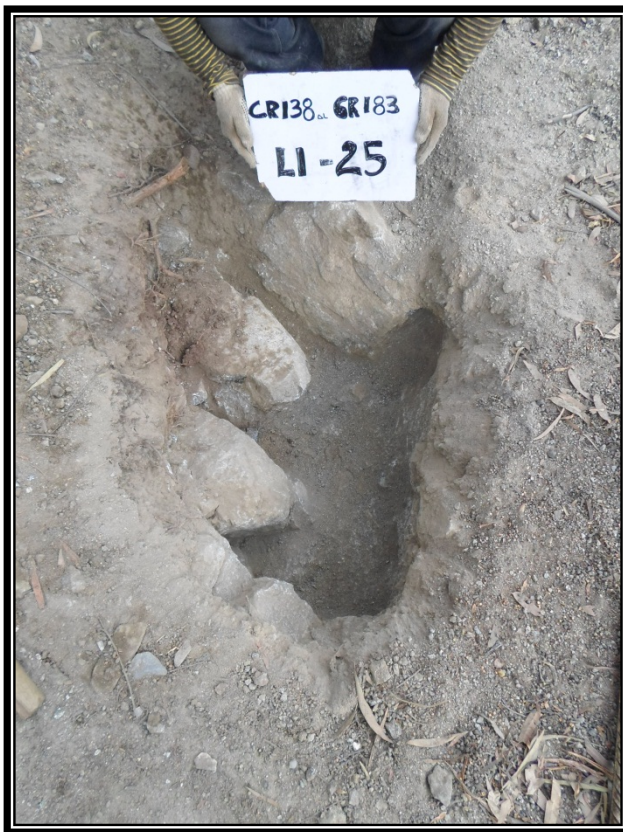
Foto N° 21 y 22: Ubicación de la calicata LI-25 se presenta un material removido conformado por arenas limosas, con presencia de gravillas de \frac{1}{2} " aisladas y raíces en un espesor de 0.10m, continuando hasta la profundidad de 0.50m con la roca intrusiva (granodiorita), en estado muy meteorizado, al excavar se presenta como arena limosas, con gravas, en estado semicompacto a compacto, subyaciendo hasta la profundidad explorada de 0.60m con la roca intrusiva (granodiorita), en estado sano de difícil excavación manual.
