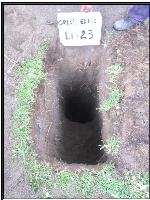
Foto N° 17 y 18: Ubicación de la calicata LI-23 se presenta un material removido conformado por arenas de grano grueso, no plástica, de color beige, húmeda, con gravas angulosas de tamaño 1\frac{1}{2} ", en estado semicompacto.
