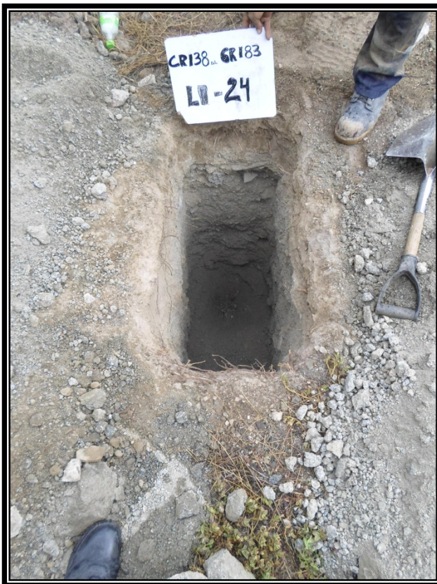
Foto N° 19 y 20: Ubicación de la calicata LI-24 se presenta un material removido conformado por arenas de grano grueso, con gravillas y raíces en un espesor de 0.30m, subyaciendo hasta la profundidad explorada de 2.00m con arenas con limos, de grano grueso, no plástica, de color plomizo, con gravas angulosas de \frac{3}{4} "-1" en un 5%-10%, en estado semicompacto a compacto.
